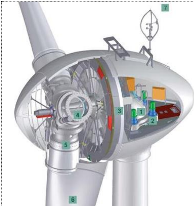
Figura 6 - Vista interior da Nacele com um gerador com transmissão direta "multipolos"(fonte Enercon, 2006)
