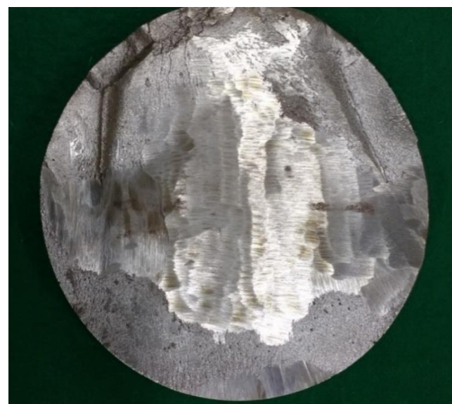
Foto 12 – Superfície fraturada preservada Fonte: Relatório Técnico 526/2018 (CEPEL)
