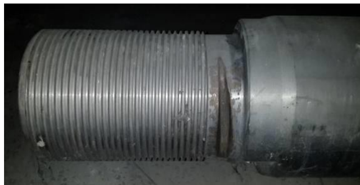
Foto 3 – Haste com Trinca Desbastada
